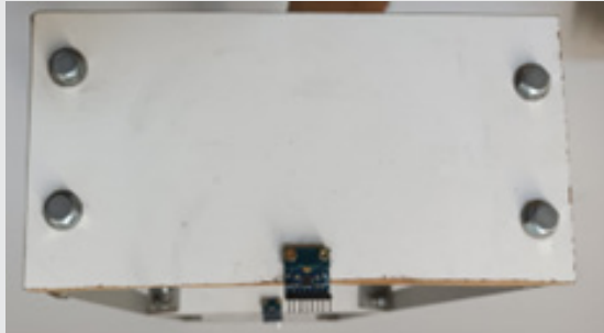
Figura 9. Vista superior de la ubicación de los módulos MPU-6050 en el edificio a escala.
