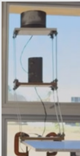
Figura 10. Deformación de las columnas del edificio a escala durante la prueba.
